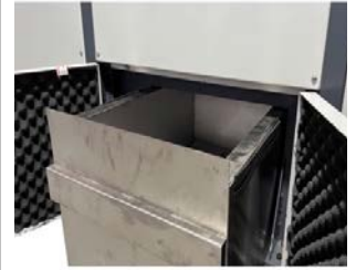
全封闭废料仓
