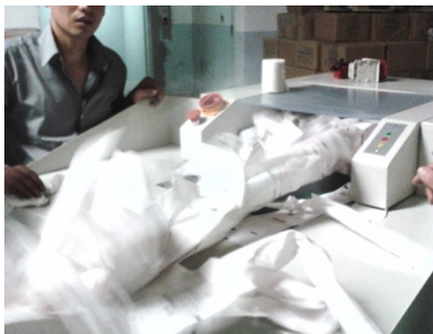
图 2: 入纸口: 大量连续的保密票据进入
